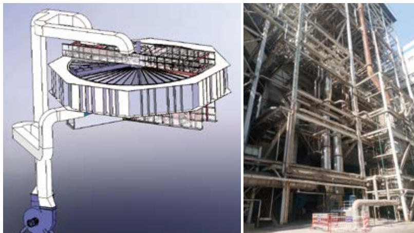
空预器 3.5 分仓防堵灰改造模型及现场
