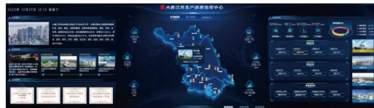
大唐江苏生产调度指挥系统由生产监控、综合业务、新能源运行管理、应急指挥、统计分析、移动APP、大屏可视化这七大功能应用组成，致力实现大唐江苏公司所属多家电厂的数据融合共享，建立从二级公司到各个电厂的联级贯通和穿透式管理，构建“一个中心，N个电厂”的智慧电力生产调度大型平台。
